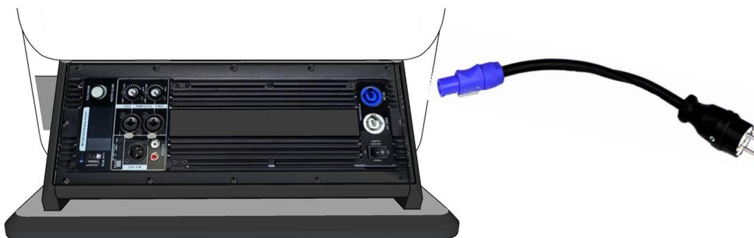
Пожалуйста подключите входящий в комплект кабель питания к электросети с напряжением 110/220 Вольт, 50/60 Гц.
