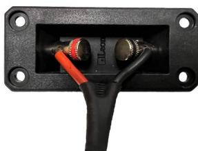
В трансформаторной версии акустический кабель подключается к АС с помощью соответствующих гнезд 4-х контактных клемм-защелок, а в Dante версии - сетевым кабелем с разъемом RJ-45.
